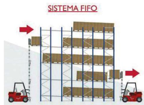
La paleta se introduce en el pasillo de carga y por gravedad se desliza sobre los rodillos hasta el lado contrario, donde está el pasillo de descarga. La primera paleta en entrar es la primera en salir.
